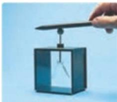
یک رسانای مخروطی شکل بدون بار را روی یک پایه عایق قرار می‌دهیم و در این حالت یک میله با بار مثبت را با مخروط تماس می‌دهیم، ۲ پرسش بعد را پاسخ دهید.
